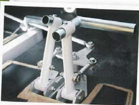
**Einsteigerfreundlich:** Durch große Flügeltüren geht's in die Kabine. Die Pedale für das gesteuerte Bugrad und das Seitenruder sind auf verschiedene Beinlängen der Passagiere und Piloten einstellbar
